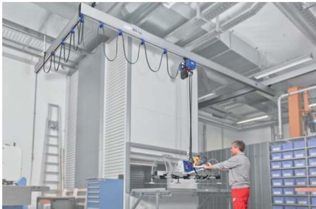
单梁铝合金桥式轨道系统与 Schmalz 真空起重机 VacuMaster Basic 应用于物料的货架堆放
