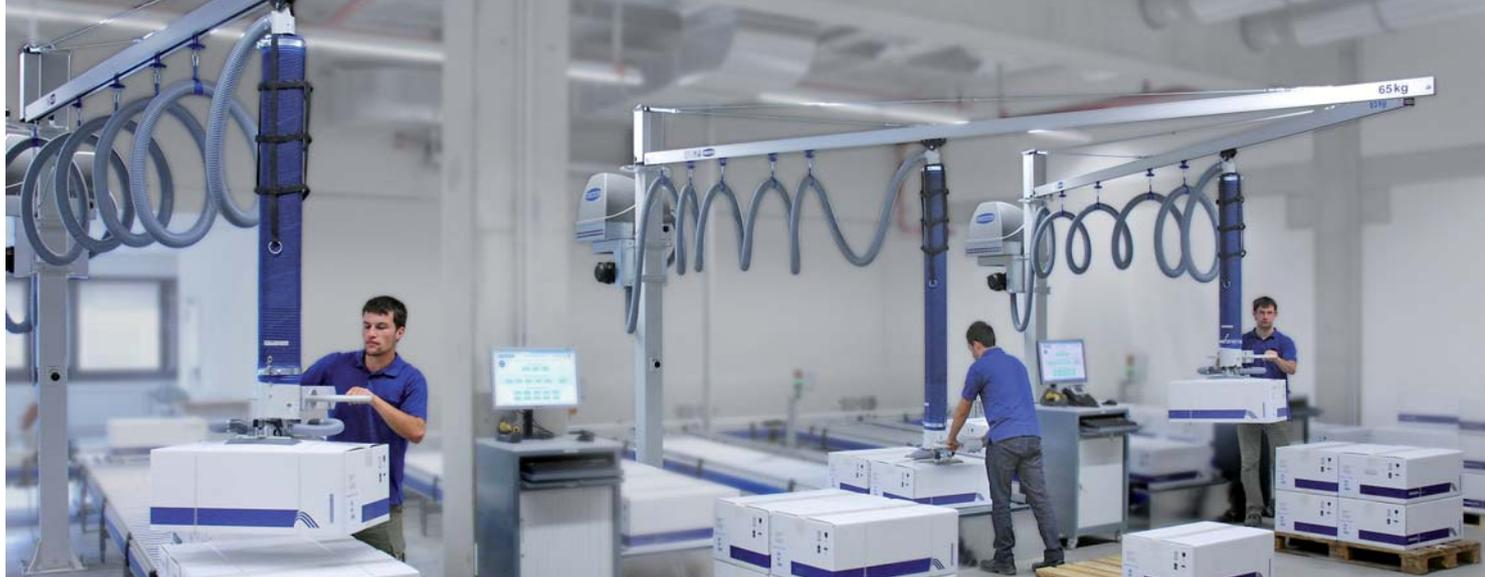
立柱铝合金悬臂轨道系统与真空管吊具 JumboErgo 在物流分拣中心的应用实例
