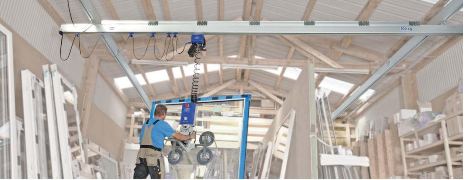
加强型单梁铝合金桥式轨道系统和 Schmalz 真空起重机 VacuMaster Window 应用于门窗工件的搬运
