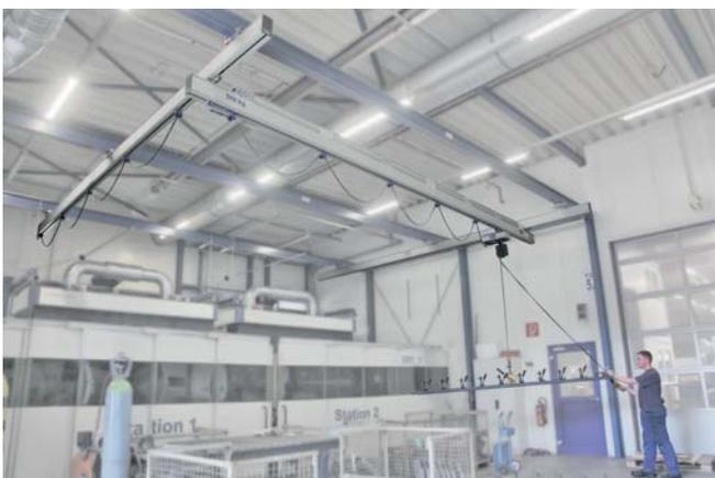
加强型单梁铝合金桥式轨道系统与环链电动葫芦应用于机加工行业的机加部件的省力化搬运
