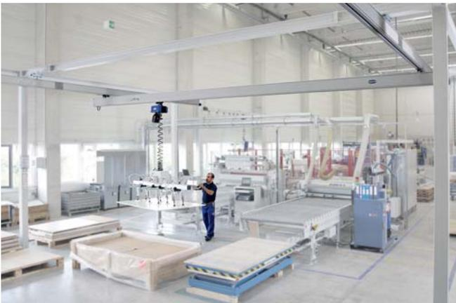
带 SCL 轨道滑触线单梁铝合金轨道系统与舒适型真空起重机 VacuMaster Comfort 应用于墙面装饰板材的省力化搬运
