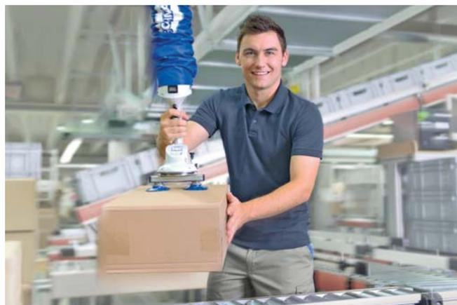
真空管吊具 JumboFlex 在分拣流水线上搬运纸箱的应用
