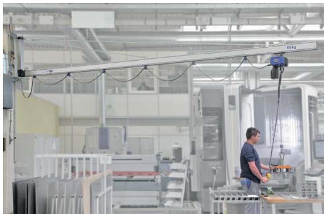
壁挂式铝合金悬臂轨道系统环链电动葫芦及磁力吸盘应用于数控机床上下料
