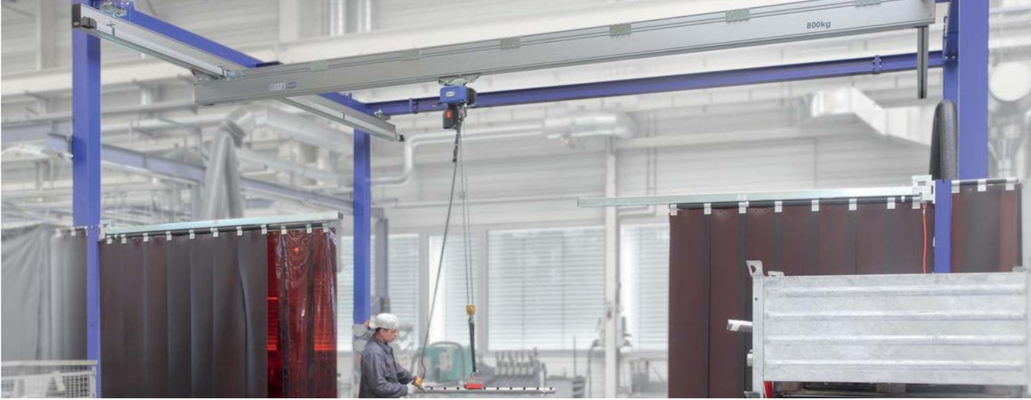
加强型单梁铝合金轨道系统带 SCL 轨道滑触线与环链电动葫芦和电磁铁在机加行业的应用
