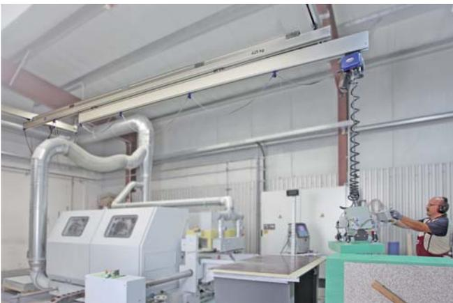
伸缩梁铝合金桥式轨道系统与 Schmalz 舒适型真空起重机 VacuMaster Comfort 应用于塑料板材的省力化搬运
