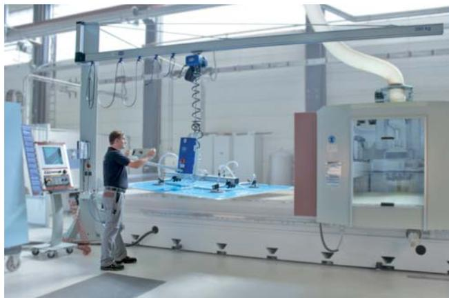
立柱铝合金悬臂轨道系统与 Schmalz 舒适型真空起重机 VacuMaster Comfort 应用于木材数控加工中心板材上下料
