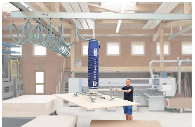
单梁铝合金桥式轨道系统与 Schmalz 真空管吊具 JumboErgo 应用于木材数控加工中心设备家具板材的上料
