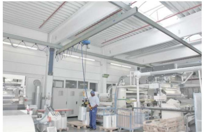
加强型单梁铝合金桥式轨道系统与环链电动葫芦应用于卷材的省力化搬运
