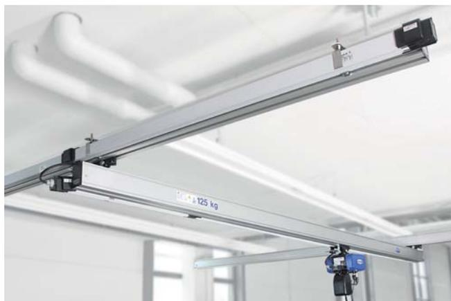
带轨道滑触线的铝合金轨道系统
