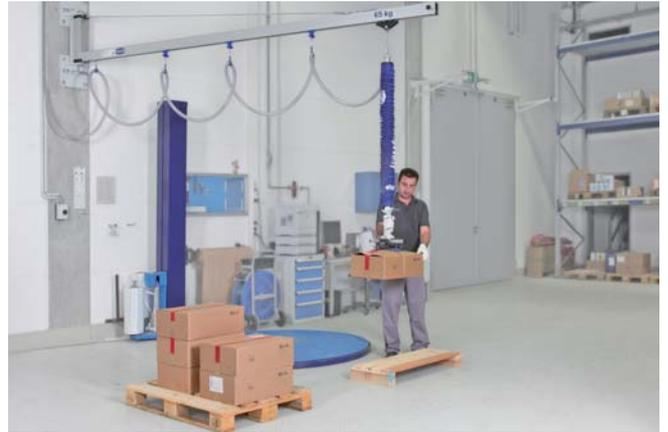
壁挂式铝合金悬臂轨道系统与真空管吊具 Jumbo 应用于纸箱搬运
