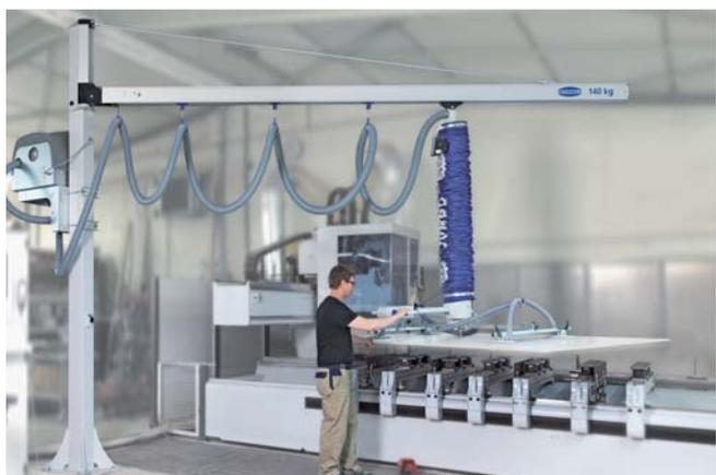
立柱铝合金悬臂轨道系统与 Schmalz 真空管吊具 JumboErgo 应用于木材数控加工中心家具板材上下料
