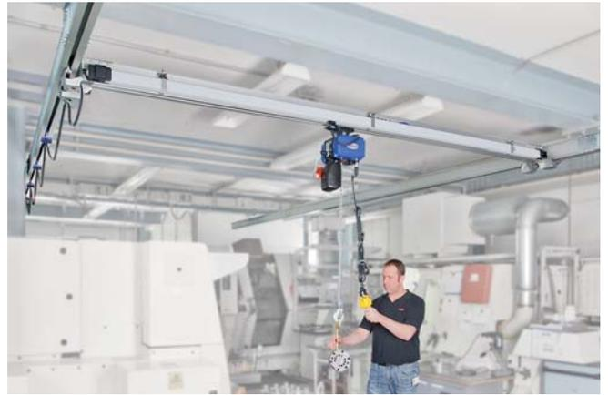
带 SCL 轨道滑触线的低空设计单梁铝合金桥式轨道系统
